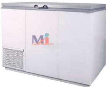
congeladores horizontal de 15 pies potencia: 1/4hp tipo de refrigerante: r-134 temperatura: -15° a -23°C controlador: electromecánico p1126 evaporador: expansión directa condensador: aluminio/hierro capacidad: 15 pies<sup>3</sup>/425 litros lamina interna: aluminio stucco aislante
