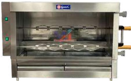
cada espetón es movido por un motor independiente con puerta corrediza en vidrio templado que permite supervisar el estado de cocción de los alimentos bandeja recoge grasas ganchos en acero inoxidable con ruedas giratorias para su mayor movilidad voltaje: 110v amperaje: 1,1abtu: 30,000 potencia: 130w consumo: 700g/h medidas: 113x52x71cm peso: 49,2kg
