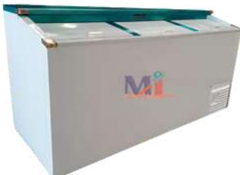
MOSTRADOR Y TAPAS EN ACERO INOXIDABLE. LOS EQUIPOS ESTÁN AISLADOS TÉRMICAMENTE POLIURETANO ECOLÓGICO INYECTADO A ALTA PRESIÓN, Y SU RANGO DE FUNCIONAMIENTO RECOMENDADO ESTA ENTRE -5°C A + 5 °C. CAPACIDAD: 26 PIES<sup>3</sup>/ 900 LITROS. POTENCIA: 1/3Hp. VOLTAJE: 110V/60Hz. MEDIDAS: 178X73X100cm.
